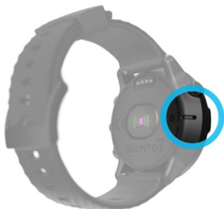
**⚠ ПРЕДОСТЕРЕЖЕНИЕ:** Следите, чтобы отверстия датчика давления воздуха не забивались грязью или песком. Не перекрывайте эти отверстия во избежание повреждения датчика.
