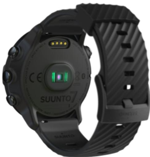
Suunto 7 содержит запястный пульсометр на базе оптического датчика, измеряющий частоту сердцебиения с помощью светодиодов, отслеживающих ток крови в запястье. Поэтому данные о пульсе доступны без поясного пульсометра как в ходе тренировки, так и при повседневном ношении.
