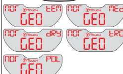
Выбор местного климата: tEM = умеренный / MEd = средиземноморский / dRY = пустынный / tRO = тропический / POL = полярный
