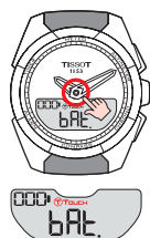
Вывод на дисплей уровня заряда элемента питания
