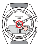
Вывод на дисплей функции выбора выходных дней для будильников (смотрите с. 8)
