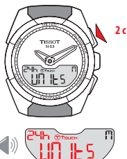
Вход в режим настройки единиц измерения времени
