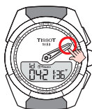
Вывод на дисплей режима измерения перепада высот
