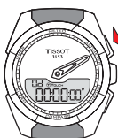
Вывод на дисплей режима измерения перепада высот
