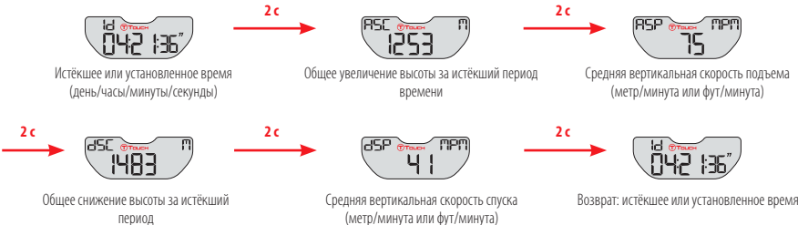
Вывод на дисплей режима измерения перепада высот
